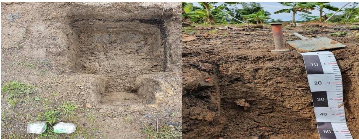
**Figura 10-** Cova medindo 40x40 para coleta de solo. **Figura 11** – Marcação da profundidade.
