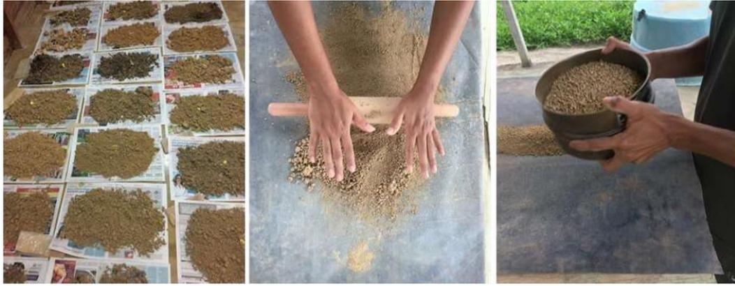
**Figura 15-** Procedimento para obtenção da terra fina seca ao ar.
