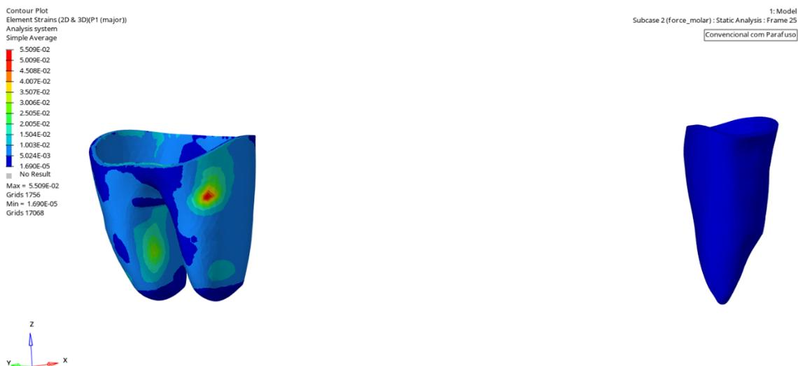
**Figura 53:** Análise de deformação na região do ligamento do primeiro molar com aplicação de carga apenas neste dente no modelo de corte convencional com parafuso. Critério de tensão principal máxima.
