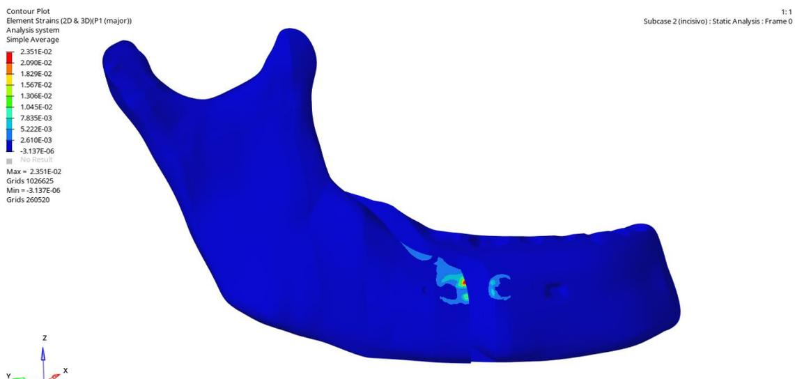
**Figura 7:** Análise de deformação apenas dos ossos cortical e medular (sem dentes ou ligamentos) com aplicação de carga apenas no incisivo central no modelo de corte baixo sem parafuso. Critério de tensão principal máxima.
