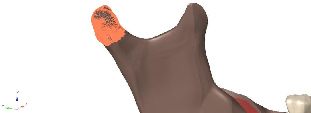
**Figura 2:** No detalhe em laranja, região de fixação da superfície articular do cômulo, sem graus de liberdade
