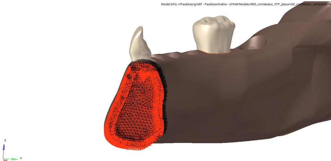
**Figura 4:** No detalhe em laranja, região de fixação de simetria da mandíbula, com 3 graus de liberdade
