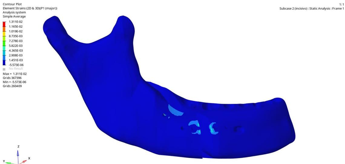
**Figura 43:** Análise de deformação apenas dos ossos cortical e medular (sem dentes ou ligamentos) com aplicação de carga apenas no incisivo central no modelo de corte baixo com parafuso. Critério de tensão principal máxima.
