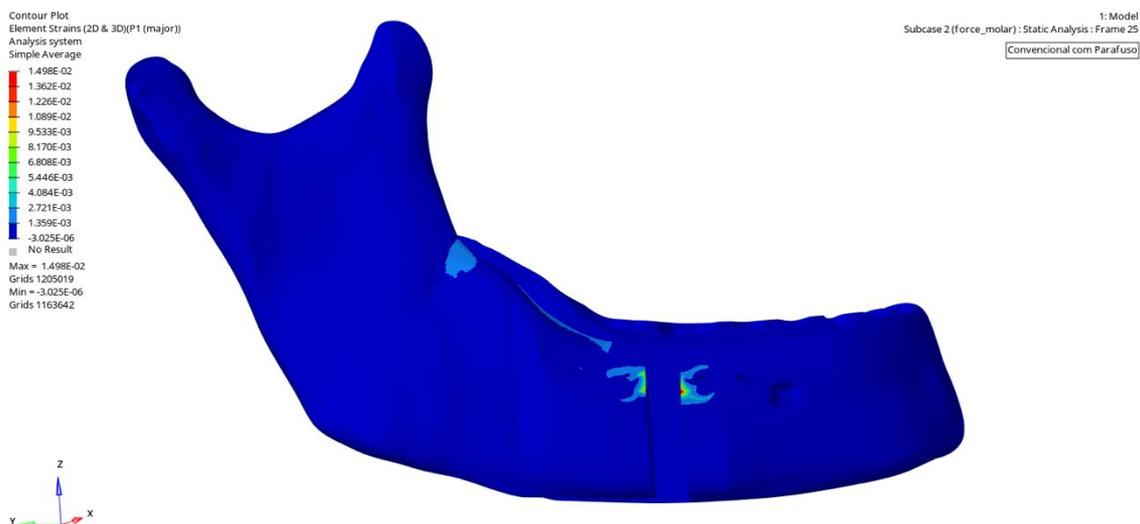
**Figura 51:** Análise de deformação apenas dos ossos cortical e medular (sem dentes ou ligamentos) com aplicação de carga apenas no primeiro molar no modelo de corte convencional com parafuso. Critério de tensão principal máxima.
