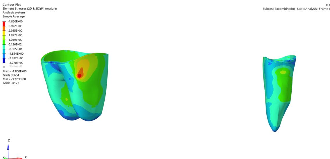
**Figura 73:** Análise de tensão nos ligamentos periodontais com aplicação de carga no incisivo central e no primeiro molar no modelo de corte baixo com parafuso. Critério de tensão principal máxima.
