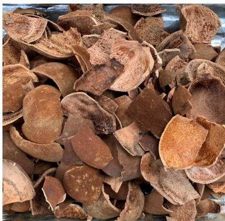
O material foi processado seguindo a metodologia adotada por (MENDONÇA, Rannier Marques, 2018). As cascas passaram por um processo de higienização e secagem em temperatura ambiente antes de serem levadas à estufa de circulação de ar, da marca/modelo Mylabor – SSDcr, onde foram submetidas a uma temperatura de 100°C por 48h para remoção da umidade, conforme Figura 6.
