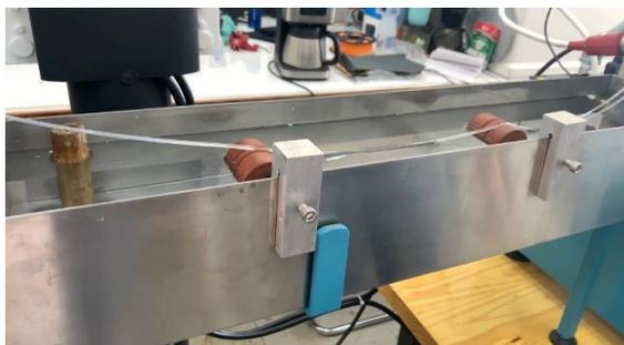
Em seguida, os fios de poliestireno puro e as diferentes concentrações de material vegetal foram submetidos ao processo de granulação, como ilustrado na Figura 14.
