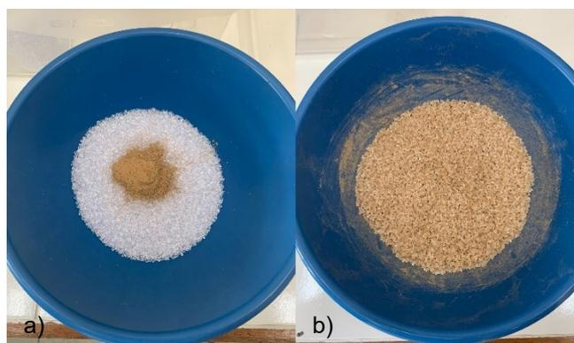
O material foi retirado da estufa e colocado em dessecador por 30 minutos para resfriamento. As extrusões do poliestireno puro e de suas concentrações com o material vegetal
