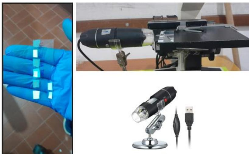
**Figura 22: Procedimento para realização do teste de molhabilidade utilizando microscópio digital eletrônico USB – Câmera endoscópio ampliação ajustável 1600x.**
