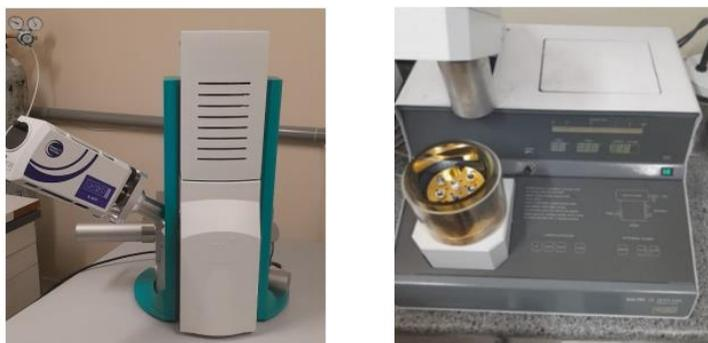
Figura 20: Microscópio TESCAN e Bal Tec, CPD 050 – Metalizador.
