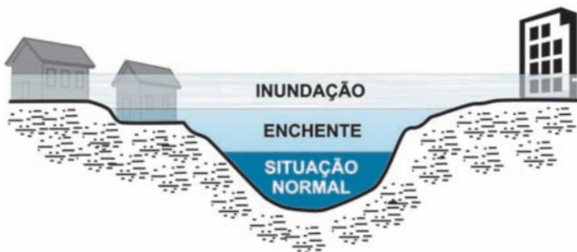
Figura 04: vazão: perfil esquemático do processo de enchente e inundação. (Fonte: Min. Cidades/IPT, 2007).
