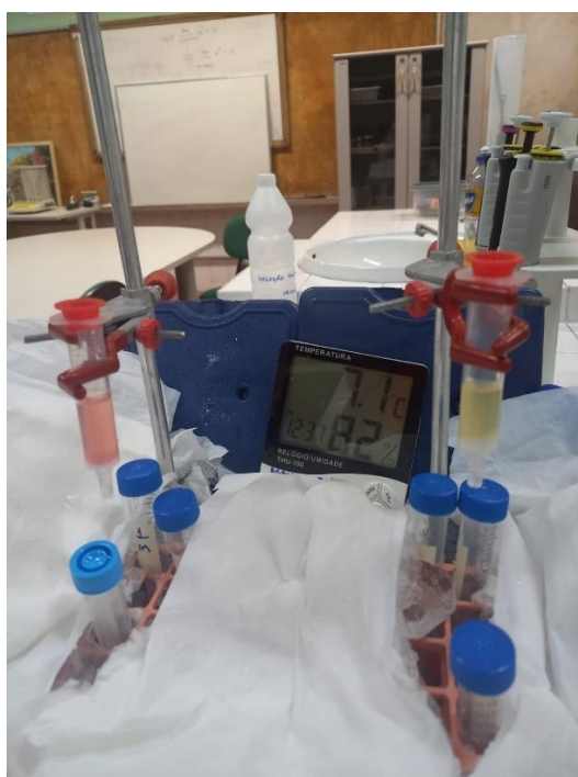
Figura 12 – Processo de purificação da glicoproteína miraculina por Cromatografia de afinidade de íons metálicos imobilizados (IMAC) com Ni-NTA agarose
