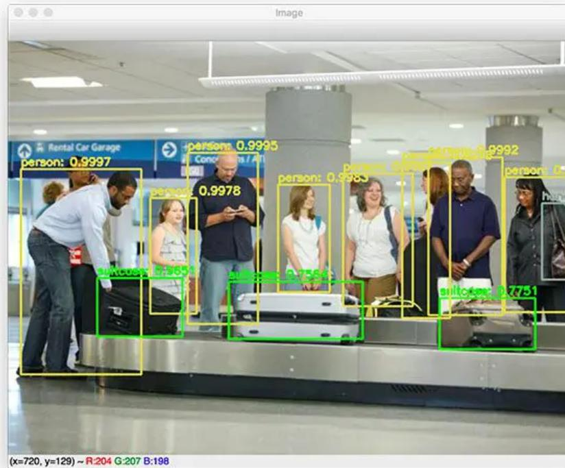
Figura 2.4: YOLO representação de detecção de Bounding boxes
