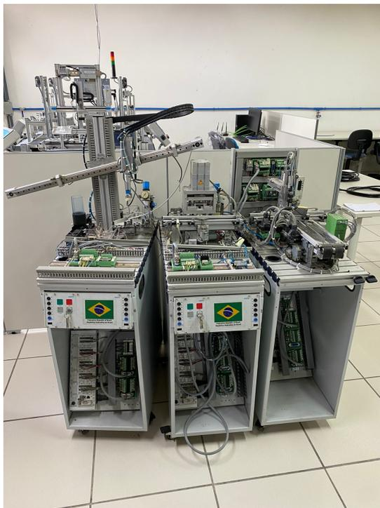
Figura 6.1: Módulo transportador, Prensa e Tampador
