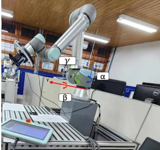
**Figura 2.5** – Representação das rotações em torno dos eixos no UR5. Fonte: Autor.
