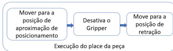
**Figura 4.3** – Fase placed do robô. Fonte: Autor, 2024.
