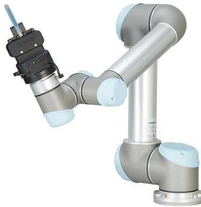
**Figura 2.3** – Robô colaborativo com módulo *pick-and-place* da UR5. Fonte: [28].
