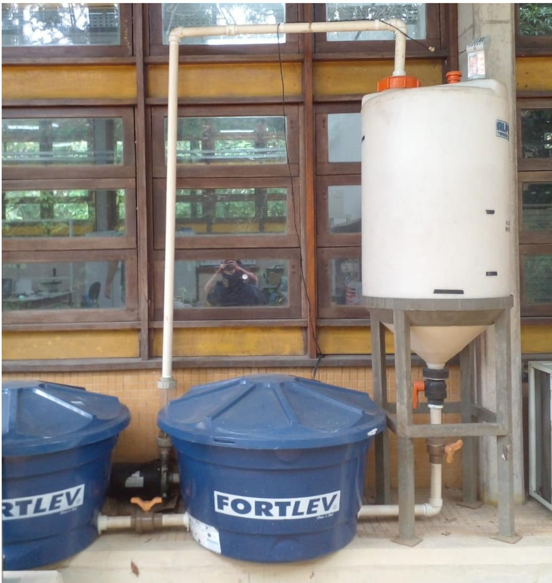
Figura 6.1: Sistema de Tanque com nível de água (branco) e reservatório de água e bomba (azul)
