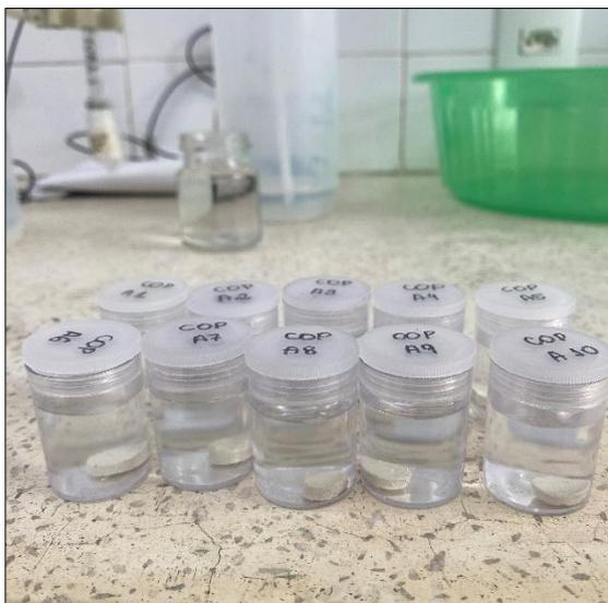
**Figura 11:** Corpos de prova armazenados individualmente em água deionizada
