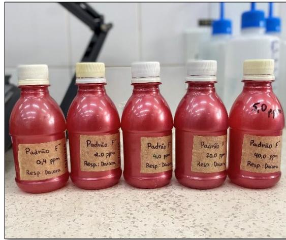
**Figura 17:** Soluções padrão utilizadas na calibração do aparelho medidor de íons flúor
