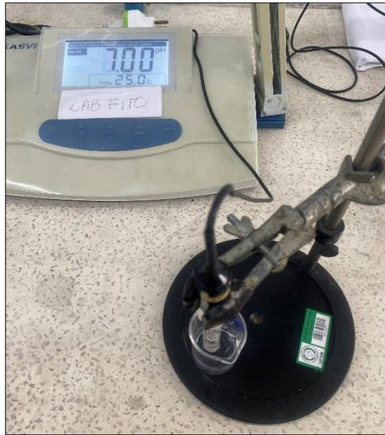
**Figura 10:** Calibração do aparelho medidor de pH
