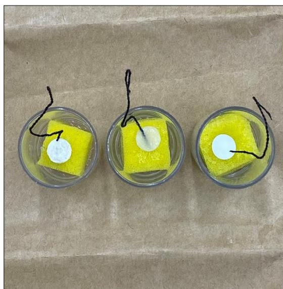
**Figura 15:** Corpos de prova em tubos de plástico com espuma úmida
