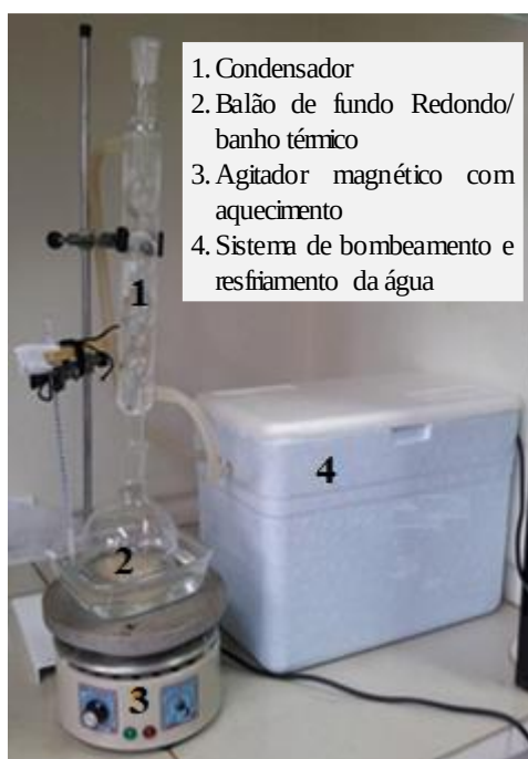
Figura 23. Sistema de refluxo aberto utilizado na reação de esterificação.
