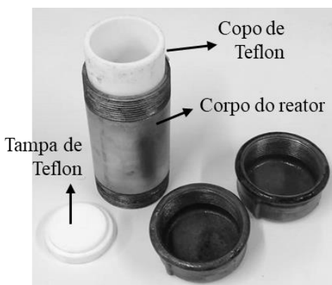
Figura 21. Reator utilizado na síntese da peneira MCM-41.
