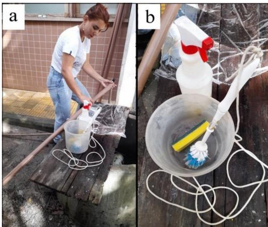
**Figura 6:** Processo de Limpeza dos tubos (a) e materiais utilizados e (b) para confecção dos piezômetros.
