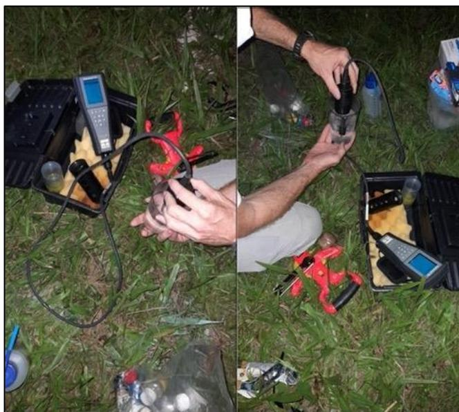
**Figura 10:** Uso da sonda multiparamétrica para as análises dos parâmetros *in situ*.
