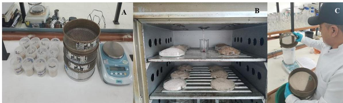
**Figura 15.** Granulometria da areia das praias de desova de *Podocnemis expansa* monitoradas e da chocadeira no Parque Nacional do Jaú, Amazonas, Brasil (A) - Amostragem de areia, peneiras de diferentes diâmetros e balança digital, (B) - Etapa de pré-secagem das amostras de areia na estufa, (C) - Pesagem das frações de areia em partículas.
