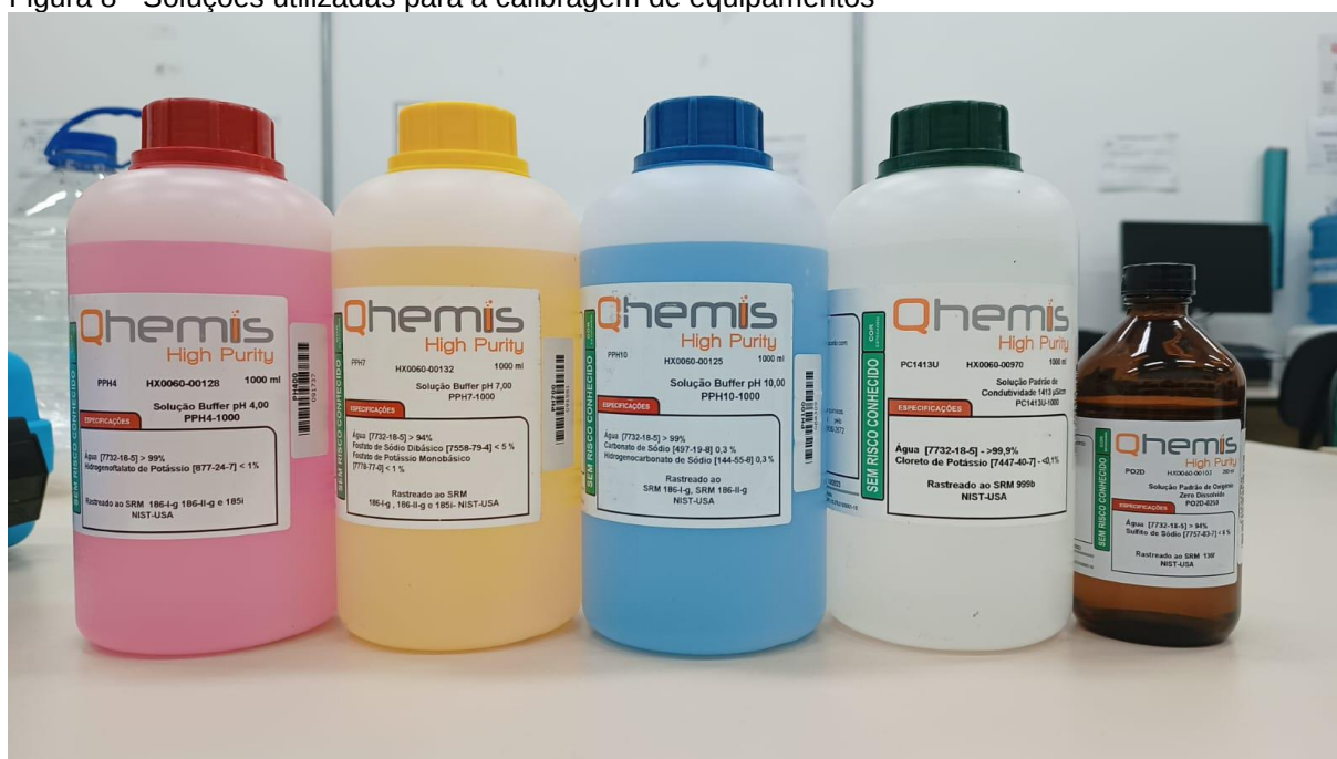
Figura 8 - Soluções utilizadas para a calibração de equipamentos
