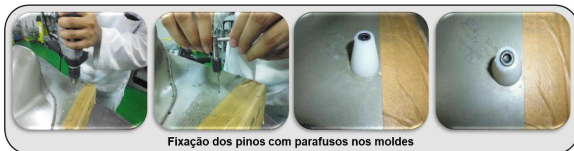
**Figura 18:** Fixação dos pinos cones com parafusos
