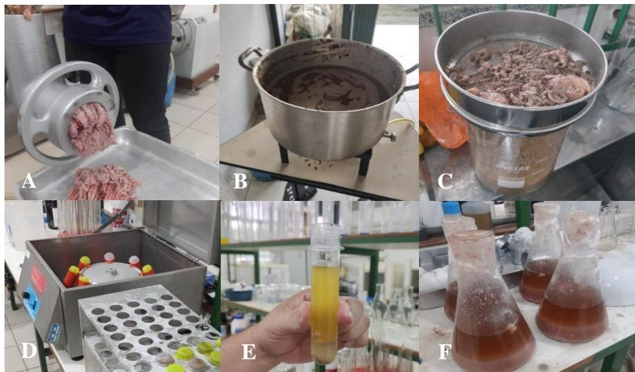
Figura 4. A- Resíduo triturado, B- Cozimento, C- Filtragem, D- Centrifugação, E- Óleo de resíduo, F- Armazenamento
