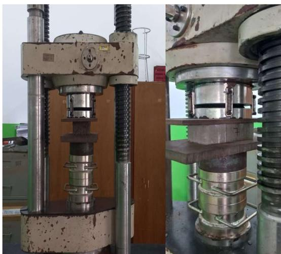
**Figura 47:** Teste resistência a compressão em andamento, amostras de pavers polimérico e concreto respectivamente.
