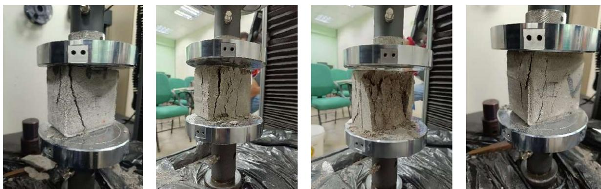
**Figura 45:** Ponto de ruptura dos pavers de concreto após compressão.
