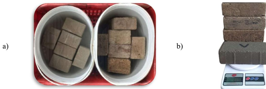
**Figura 43:** Amostras submersas em água após 24:00h (a) e conferição das massas (b). **Fonte:** Autor
