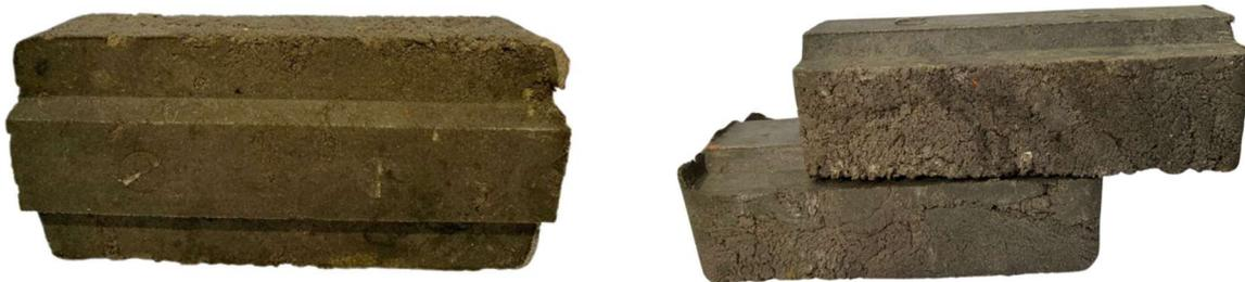
**Figura 28:** Blocos de Tijolos Areia-Polímero prensados.
