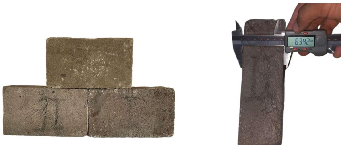
**Figura 40:** Pavers Intertravados de areia e plásticos produzidos e suas métricas.
