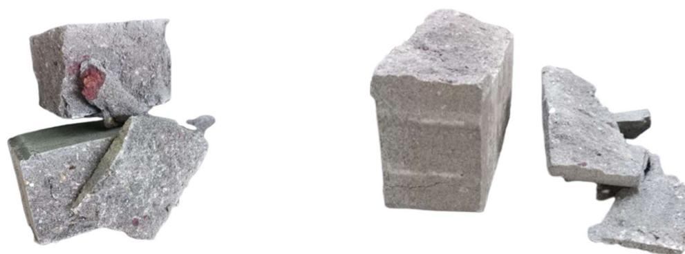
**Figura 48:** Padrão de ruptura dos pavers de concreto após compressão.
