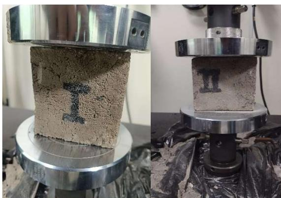
**Figura 46:** Pavers poliméricos submetidos ao teste de compressão sem apresentar ruptura ou cisalhamento.
