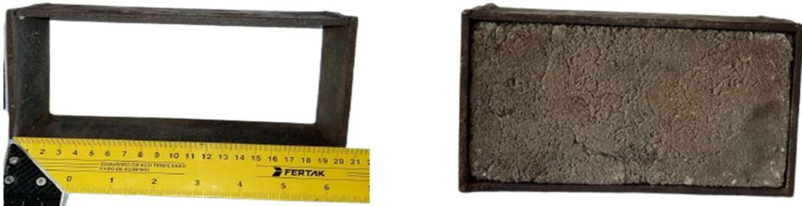
**Figura 31:** Dimensão interna do molde (A) utilizado para prensagem dos pavers.
