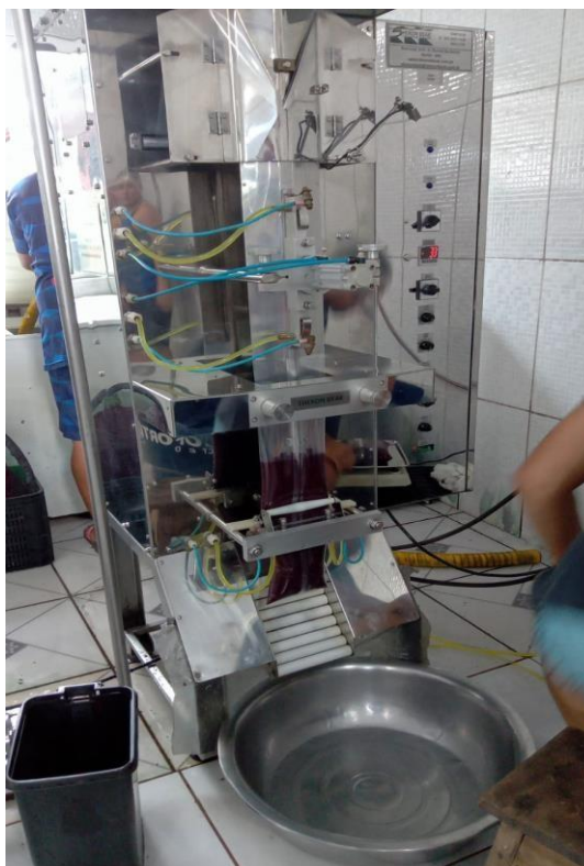
Figura 17- Máquina seladora. Foto: Leite, C. M., 2022.
