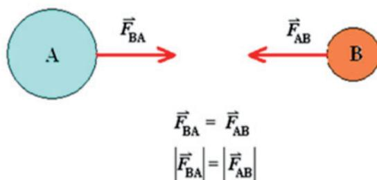
Essa lei é fundamental para entender as interações entre os corpos e é aplicável em várias situações do cotidiano. Por exemplo, quando você empurra uma parede, a parede exerce uma força de reação em você com a mesma intensidade, mas na direção oposta. Isso explica por que você sente a resistência da parede ao empurrá-la.
