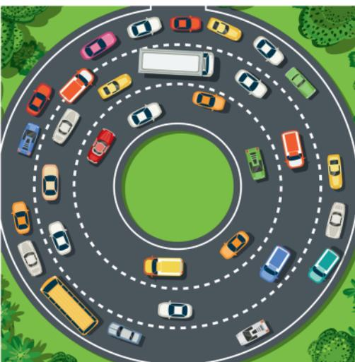
Para que um carro permaneça em uma curva circular, a força necessária para mantê-lo na trajetória é fornecida pela fricção entre os pneus e a pista. Essa força centrípeta, que age em direção ao centro da curva, é essencial para que o carro não deslize para fora da pista. A quantidade de fricção necessária depende da velocidade do carro e do raio da curva.
