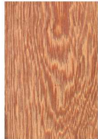
Figura 7. Angelim pedra: exemplo de veios da madeira aparentes em corte longitudinal Fonte. Espécies Nativas com Potencial Madeireiro e Moveleiro (ZENID, 2010)
