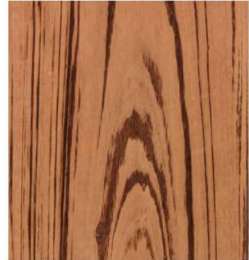
Figura 3. Faia: exemplo de veios da madeira aparentes em corte longitudinal Fonte. Espécies Nativas com Potencial Madeireiro e Moveleiro (ZENID, 2010)
