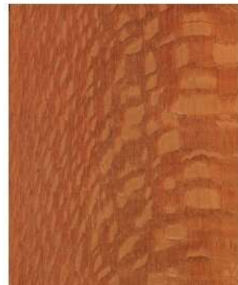
Figura 6. Louro-faia: exemplo de desenho em peça radial Fonte. Espécies Nativas com Potencial Madeireiro e Moveleiro (ZENID, 2010)
