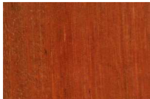
Figura 4. Angelim Vermelho: exemplo de veios da madeira aparentes em corte longitudinal Fonte. ECOLOG,2022.
