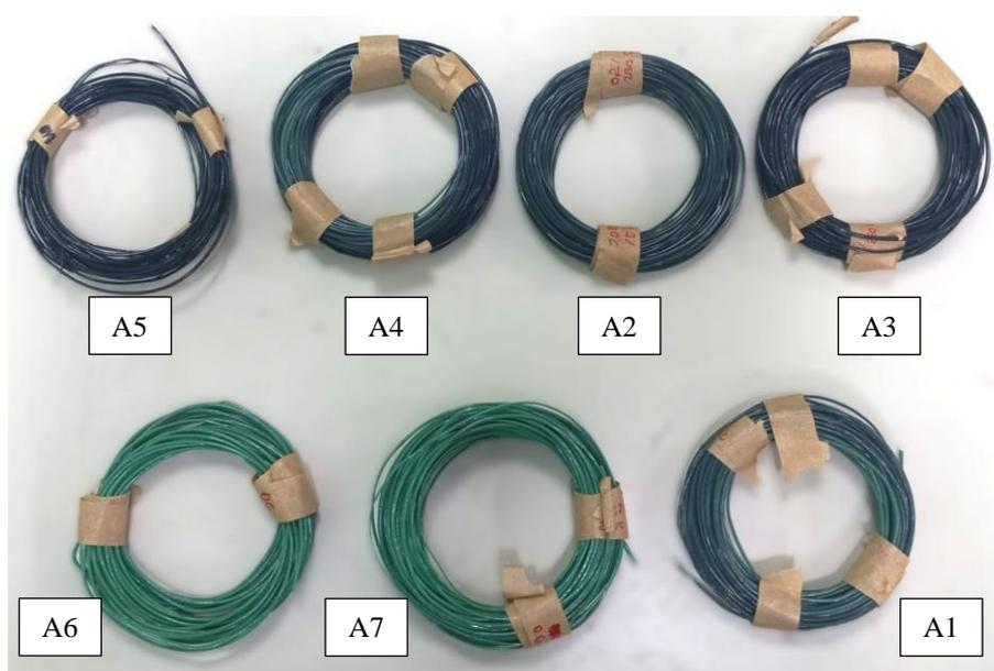
Figura 18: Filamentos obtidos do processo de extrusão. Fonte: Autor.
