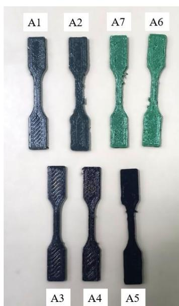
Figura 22: Corpos de prova impressos. Identificação de acordo com a Tabelas 6 e 7. Amostras A1-A5 (PLA/NTC) e A6 e A7 (PLA/OG). Fonte: Autor.
