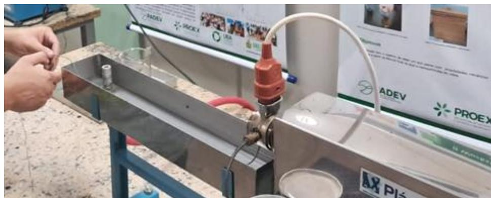
Figura 17: Etapa de extrusão dos filamentos: Fonte: Autor.
