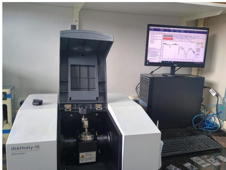
Figura 7 Espectrofotômetro infravermelho IRAffinity-1S.
