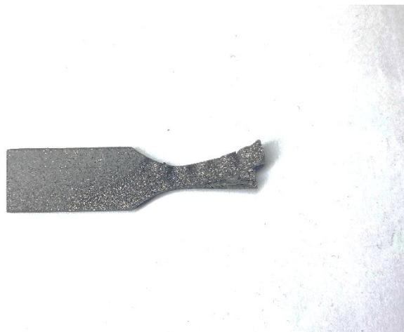
Figura 39 Corpo de prova de resina ABS-Like com adição de 10% de Grafite com falha de impressão.
