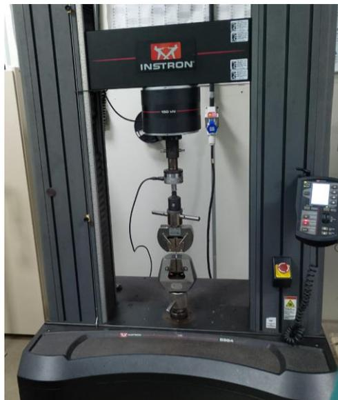
Figura 9 Máquina de ensaios mecânicos INSTRON, modelo 5582.
