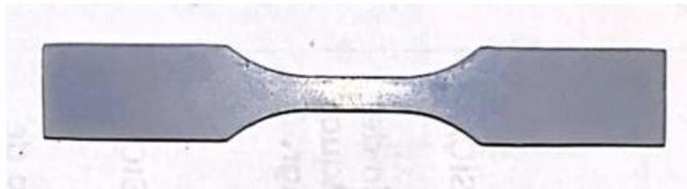
Figura 16 Corpo de prova impresso.
