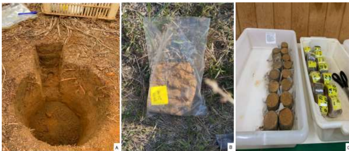
Figura 7– Metodologia de campo: A = abertura de pequenas trincheiras; B = amostras em sacos plásticos; C = amostras em anéis volumétricos.
