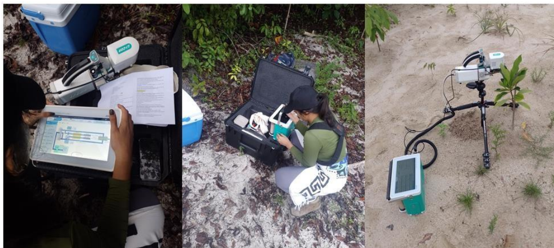
Figura 13. Ajuste do equipamento IRGA e leitura dos aspectos fisiológicos das espécies.
