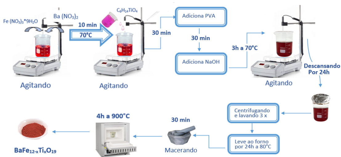
Figura 4.1: Rota de síntese por coprecipitação
