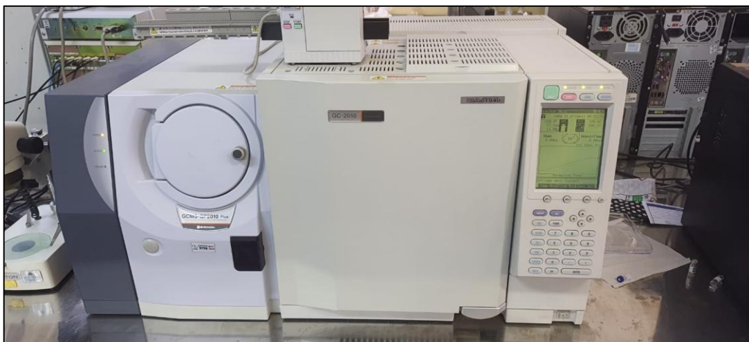
Figura 15. Equipamento GC-MS do Laboratório da Central Analítica da Escola Superior de Ciências da Saúde (ESA), localizado na Universidade Estadual do Amazonas – UEA. Fonte: O autor (2025).
