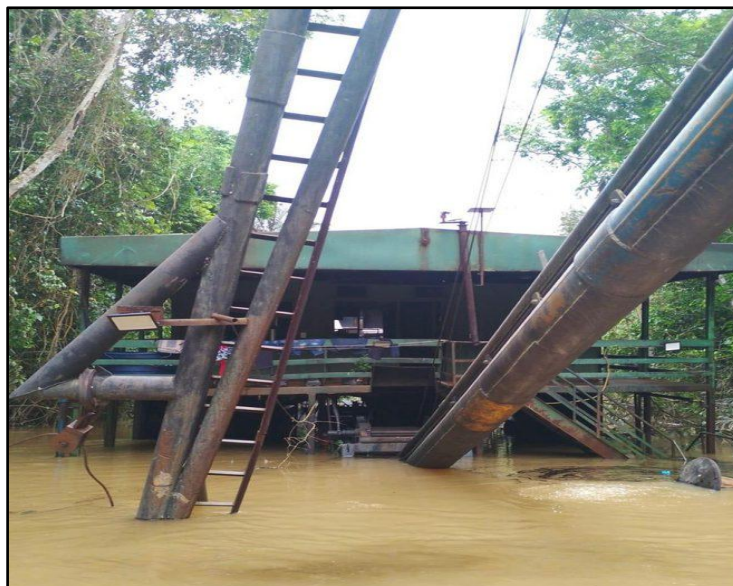
Figura 46. Balsa utilizada para extração de ouro
