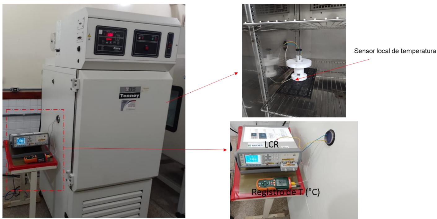
Figura 20 - Registro fotográfico do experimento para realização dos testes de impedância eletroquímica em estado sólido
