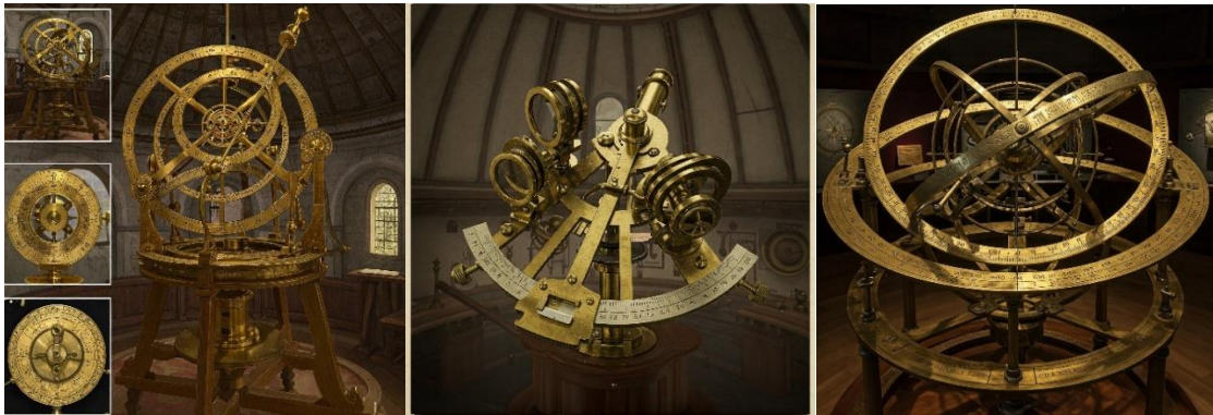
Figura 12 - Instrumentos usados por Tycho Brahe. À esquerda, o quadrante de azimute de 3 metros, no centro o sextante de cerca de 1,8 metro e a grande armilar equatorial à direita, com cerca de 4,8 metros de altura.
