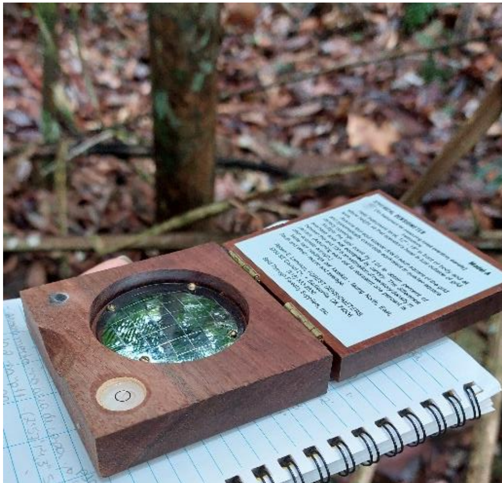
Figura 10. Equipamento denominado densiômetro esférico, utilizado para obter a estimativa do fechamento do dossel durante a visita a campo. Fonte: autora.
