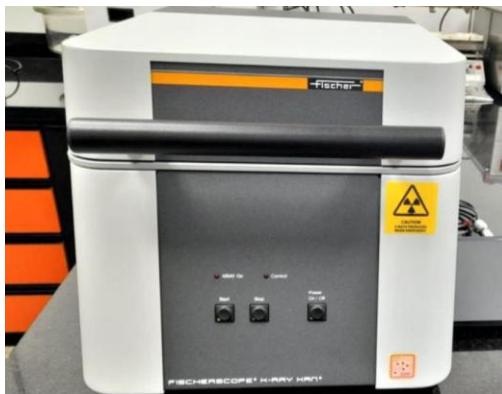
Figura 15. Espectrômetro de FRX FISCHERSCOPE X-RAY, modelo XAN 250. Fonte: LSCN/IFAM.
