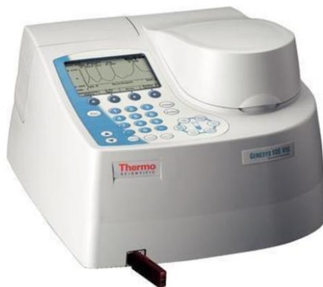
Figura 14. Espectrofotômetro UV-Vis Thermo Scientific™, modelo GENESYS 10S. Fonte: Laboratório de Físico-Química/UFAM.
