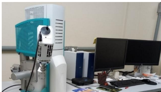
Figura 13. Microscópio eletrônico de varredura Tescan, modelo Vega 3. Fonte: LTMN/INPA.
