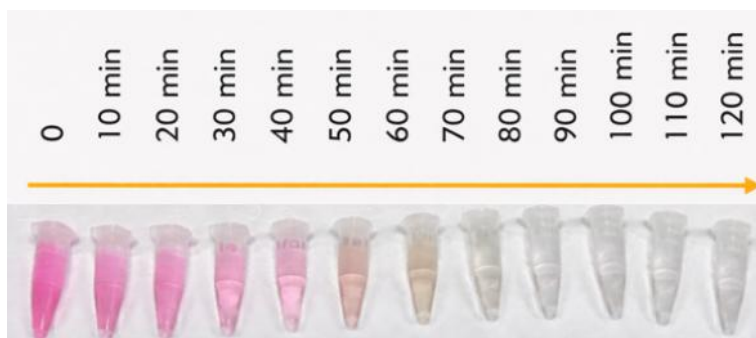
Figura 27. Alíquotas do corante de RhB sob efeito do catalisador \text{Ag}_3\text{PO}_4/\alpha\text{-FeOOH} durante exposição a luz visível durante 120 min. Fonte: Autor, 2020.
