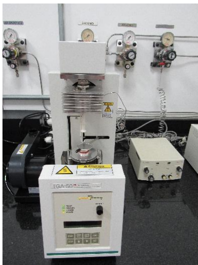
Figura 12. Termoanalizador Shimadzu, modelo TGA-50. Fonte: LSCN/IFAM.
