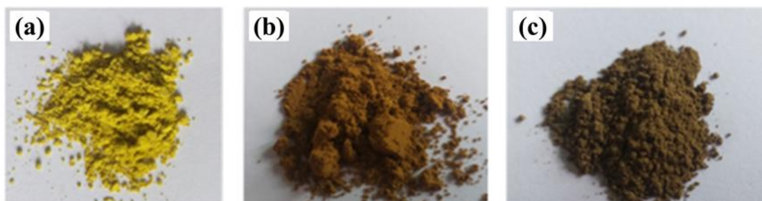
Figura 17. Imagens das amostras preparadas: (a) amostra FFP, \text{Ag}_3\text{PO}_4 ; (b) amostra GTT, \alpha\text{-FeOOH} ; e (c) amostra HGP, \text{Ag}_3\text{PO}_4/\alpha\text{-FeOOH} . Fonte: Autor, 2020.
