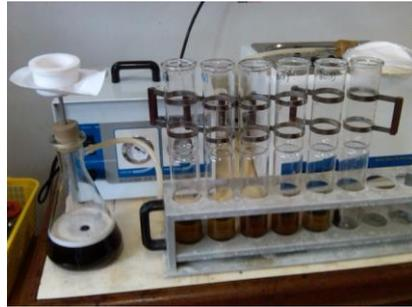
**Figura 9.** Filtração á vácuo
