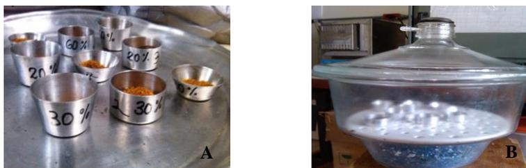
**Figura 6.** Análise da umidade das amostras estudadas. **A.** Amostras trituradas nos cadinhos identificados. **B.** Dessecador
