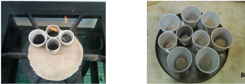
**Figura 7.** Análise do teor de cinzas das rações. **A.** Amostras de ração carbonizadas. **B.** Amostras de ração incineradas.
