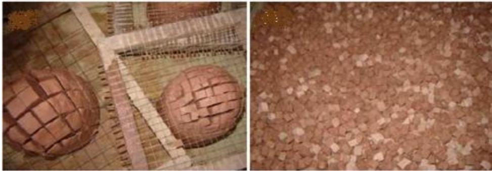
Figura 12 – ASAC: Agregados produzidos de forma artesanal
