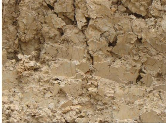
Figura 31 – Amostra do Solo matéria-prima para confecção dos ASACs.
