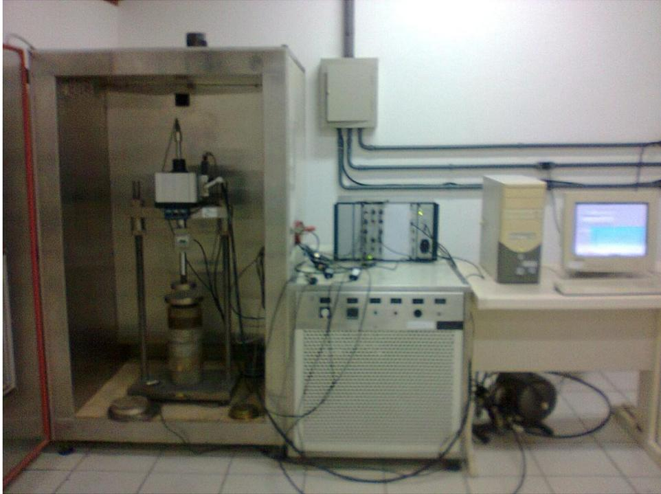
Figura 38 – Máquina universal de ensaios com capacidade de carga de 14 kN.
