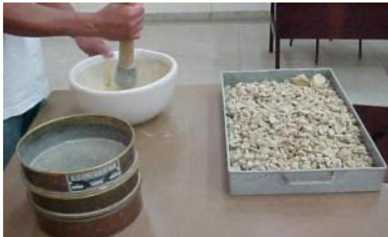
Figura 32 – Solo fracionado em pelotas sendo destorroadado e peneirado.
