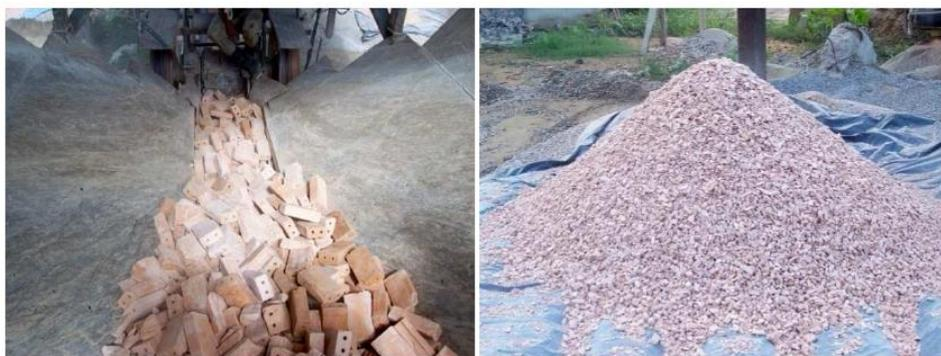
Figura 13 – ASAC: Agregados produzidos em olaria
