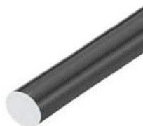
FIG. 1. Amostra de aço 1020
