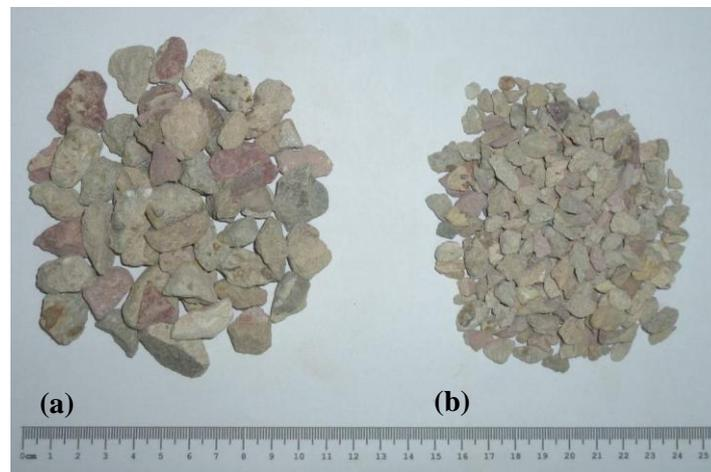
**FIGURA 6** - Agregados de Resíduo de Construção e Demolição nas frações correspondentes à (a) Brita 1 e (b) Brita 0
