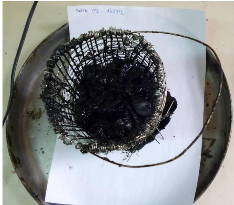
**FIGURA 20** - Ensaio de Escorrimento após o Acondicionamento em Estufa
