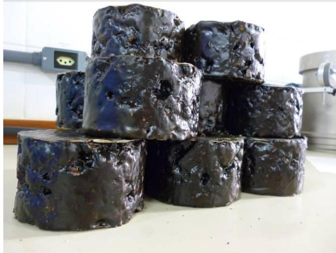
**FIGURA 19** - Misturas Asfálticas SMA parafinadas na condição compactada para ensaio de Densidade Aparente
