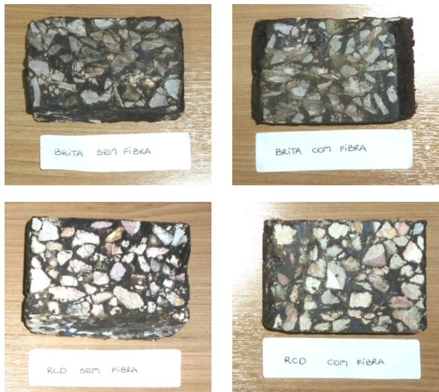
**FIGURA 42** – Seção dos Corpos de Prova na Dosagem Mineral selecionada e Teor “Ótimo” de CAP
