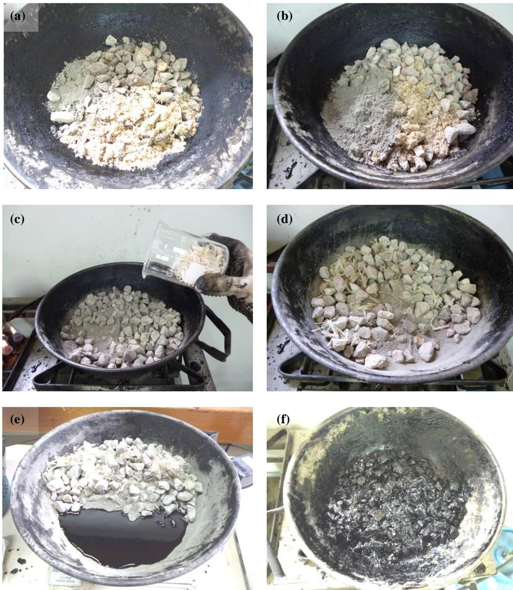
**FIGURA 14** - Esquema da execução da mistura asfáltica SMA com a fibra do Curauá: mistura mineral (a) com Brita e (b) com RCD, (c) inserção das fibras, (d) mistura dos agregados e fibras, (e) pesagem do ligante asfáltico e (f) aspecto da mistura asfáltica.
