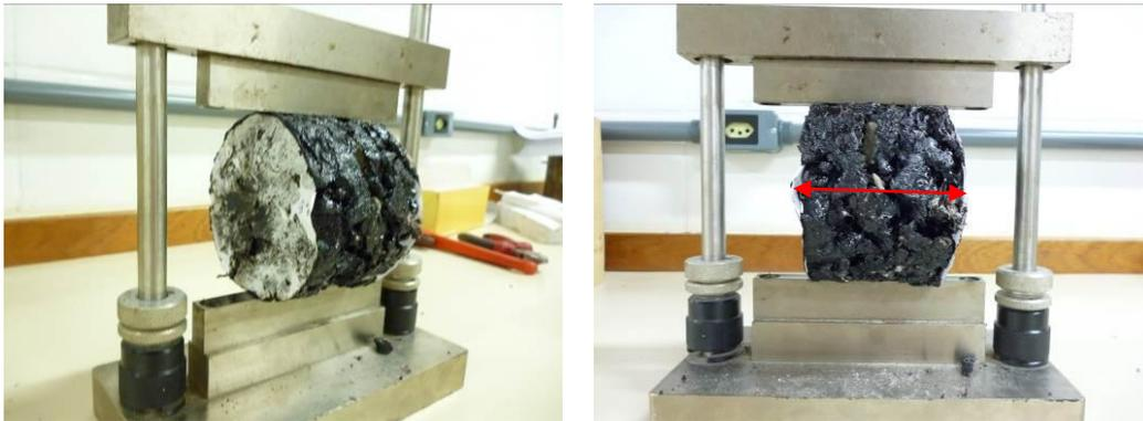
**FIGURA 52** - Aspecto do Corpo de Prova no Ensaio de Resistência à Tração a 60°C
