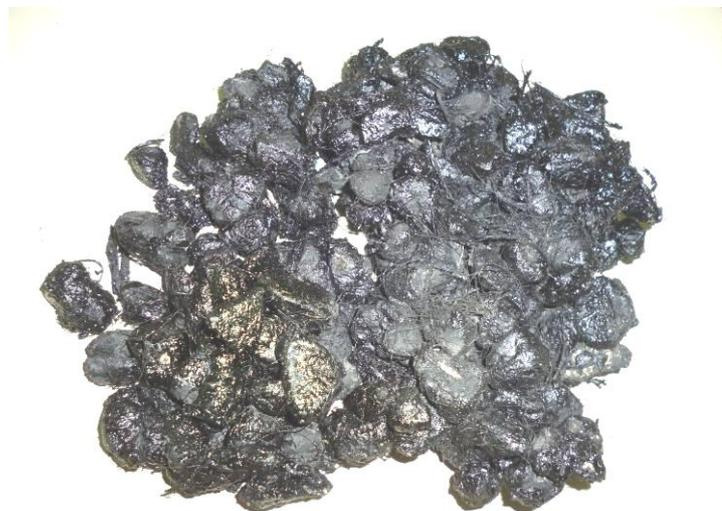
**FIGURA 18** - Mistura Asfáltica SMA na Condição Solta para Ensaio de DMM
