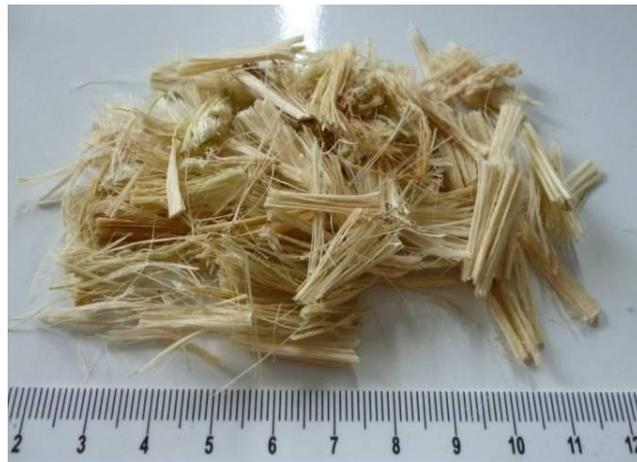
**FIGURA 10** - Fibra do Curauá: frações cortadas para uso na mistura asfáltica
