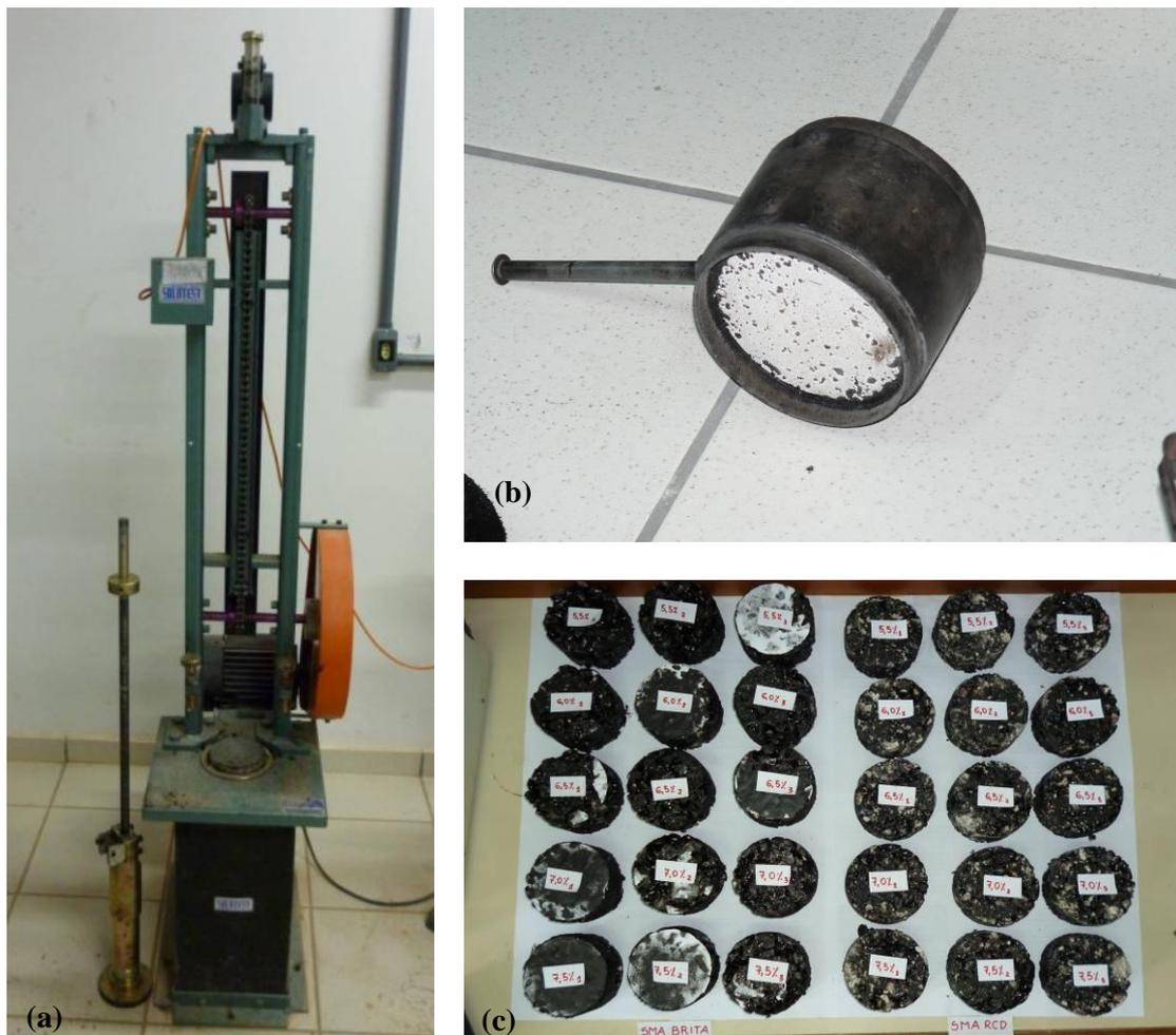
**FIGURA 17** - (a) Compactador Marshall, (b) Mistura compactada no molde Marshall e (c) Corpos de Prova para Dosagem da Mistura Sem Fibra
