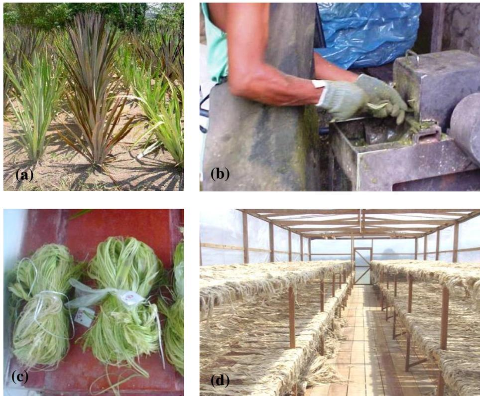
**FIGURA 4** - (a) Plantação de Curauá Branco e Roxo, (b) Extração da Fibra da Folha do Curauá, (c) Fibras do Curauá processadas e (d) Secagem das Fibras do Curauá
