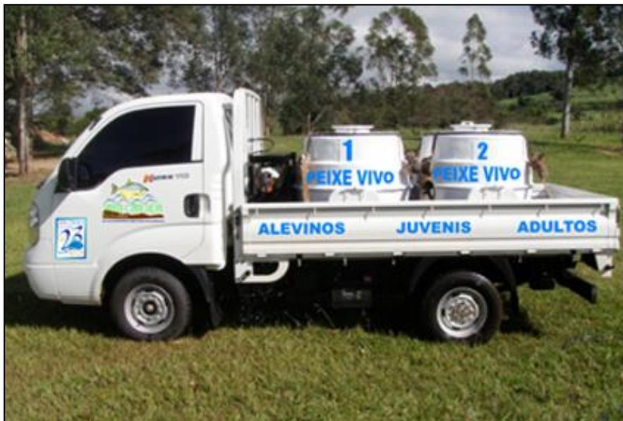
**Figura 8.** Veículo adaptado com caixas para o transporte de peixes vivos.
