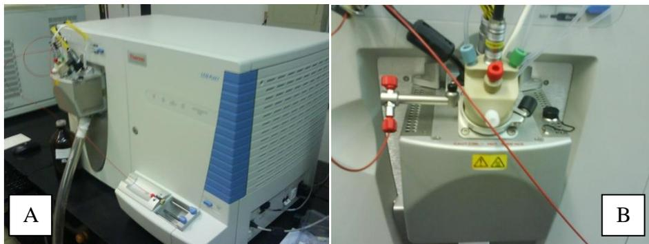
**Figura 9.** (A) Espectrômetro de Massas e (B) Injetor da Amostra em detalhe.
