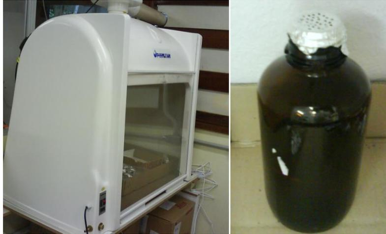
**Figura 21.** Secagem do EGB na capela (à esquerda). Frasco com EGB para secagem dentro da capela.
