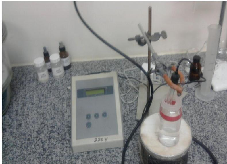
**Figura 23** potenciômetro para determinação de pH
