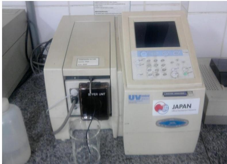
**Figura 22** - Espectrofotômetro UV-VIS (660 nm) para leitura de fósforo (P)
