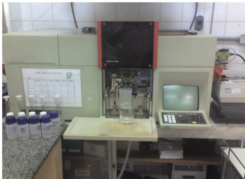
**Figura21** - Espectrofotometria de Absorção Atômica (EAA).
