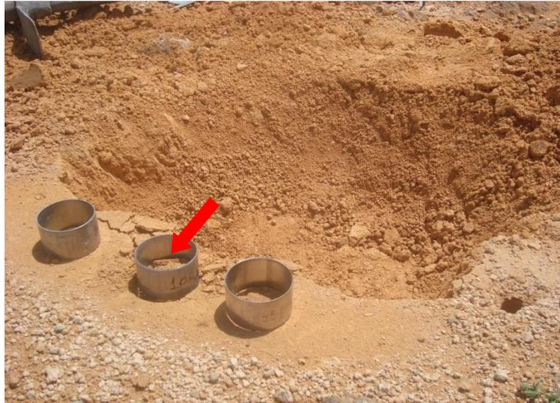
**Figura 20** A seta vermelha indicando os três cilindros de copecky para coleta de solo para análise de densidade
