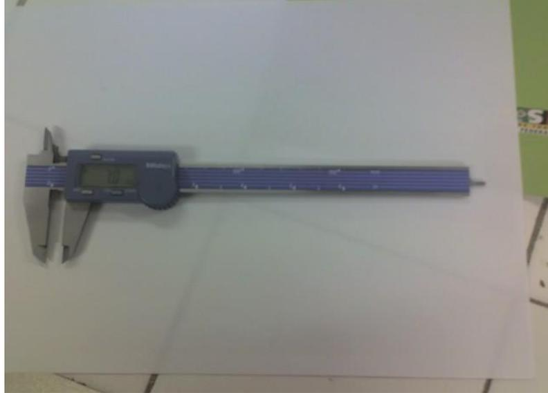
**Figura 30:** Paquímetro digital usado para obtenção de medidas de diâmetro a 10 cm do solo.
