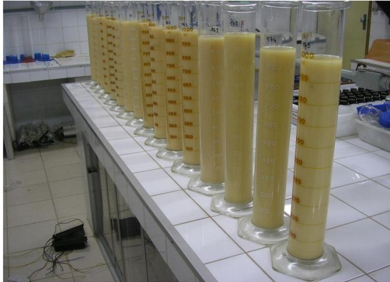
**Figura 15:** Análise granulométrica: provetas após serem agitadas aguardando o tempo de decantação para coleta do material em suspensão.
