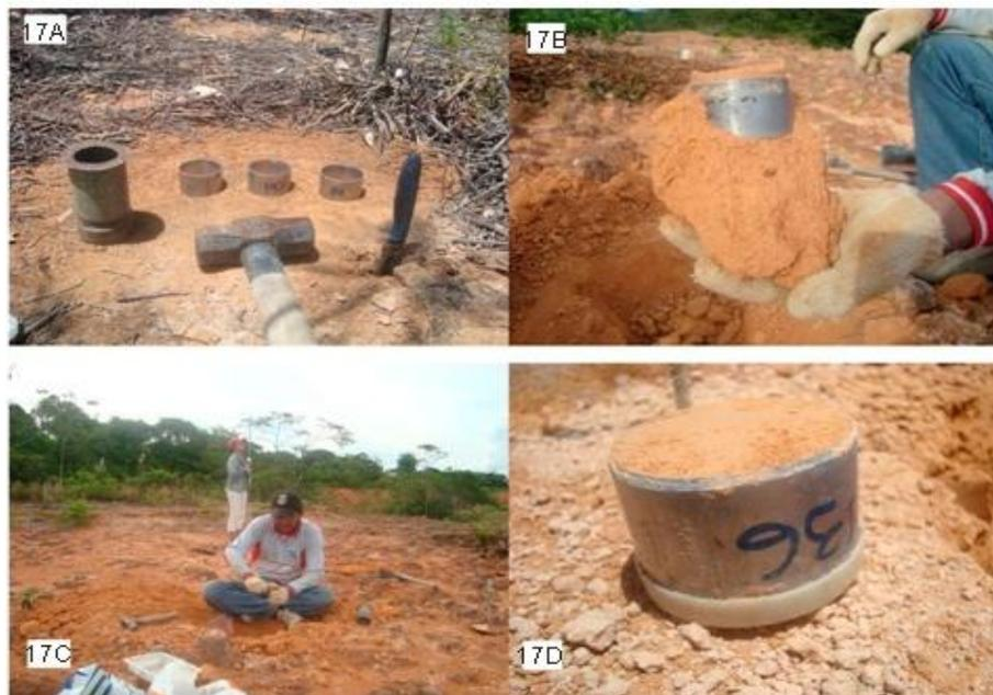
**Figuras 17 a:** Material utilizado para coleta de Densidade Aparente, **b** Cilindro com solo, **c** Limpeza do cilindro, **d** Cilindro após limpeza.
