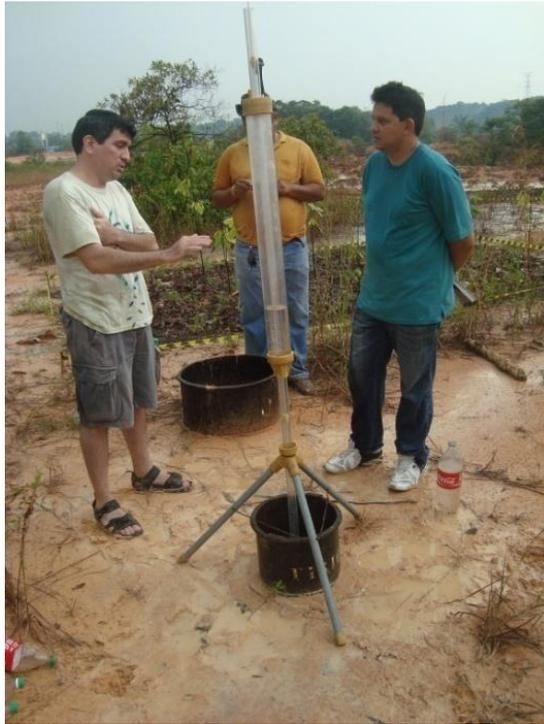
**Figura 29.** Permeâmetro de Guelph sendo instalado para coleta de dado.
