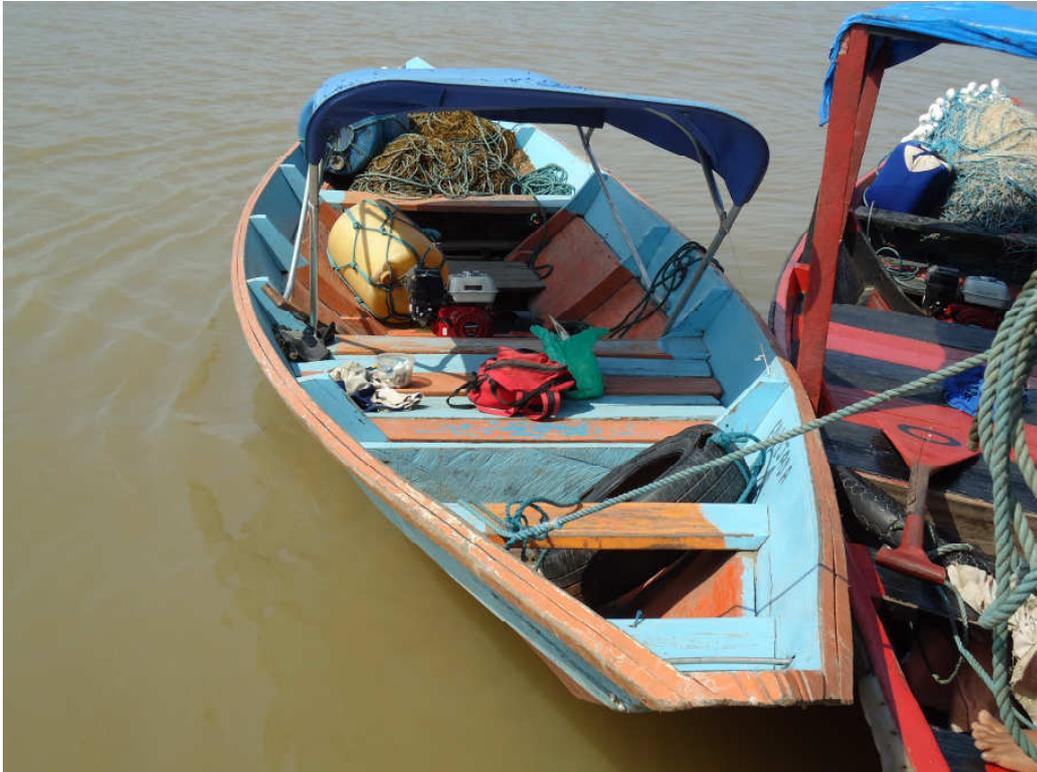
Fig. 15: Canoa com motor ao centro em estrutura de alumínio e lona. Abreu, 2010.
