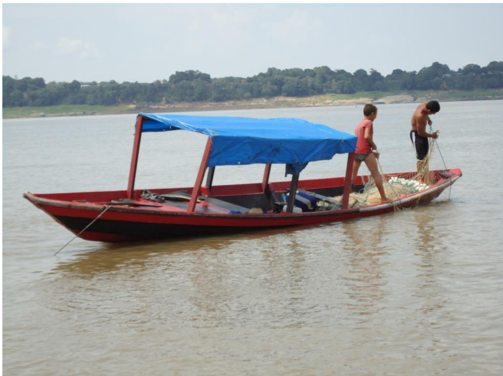
Fig. 16: Canoa com motor ao centro em estrutura de madeira e lona. Abreu, 2010.
