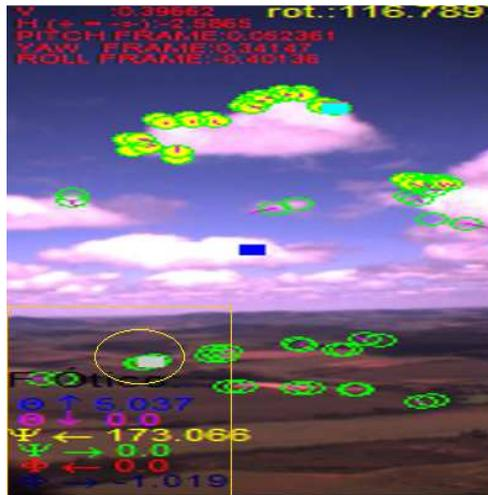
**Figura 27.** Ponto cinza escolhido para o cálculo dos ângulos de Ataque e Guinada, destacado pelo círculo amarelo. O quadrado em cor laranja mostra a área de interesse tomada para a escolha do ponto.
