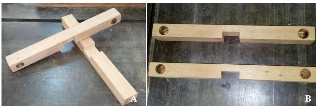
Figura 38: A. Peças prontas para colagem; B. Furos para facilitar a inserção das porcas.
