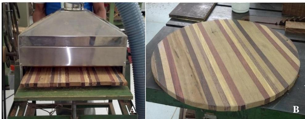
Figura 36. a. Painel com diversas espécies coladas; b. Painel cortado para formação do tampo.
