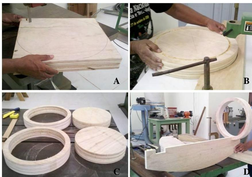
Figura 30: A. Corte na serra fita; B. Retirada da parte interna da peça, C. Anel Central cortado e Pernas.
