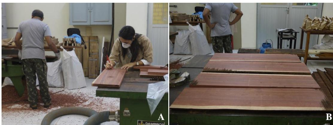
Figura 32. A. Anotação das pranchas; B. Processamento em pranchas de menor espessura.
