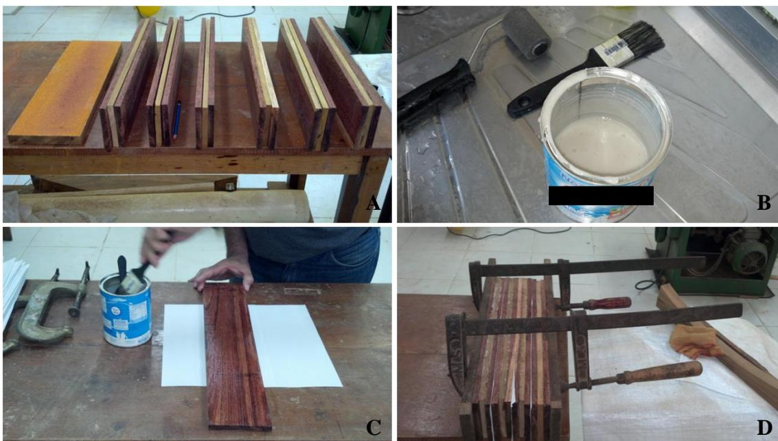
Figura 34: A. Peças para a colagem; B. Cola preparada; C. Processo de colagem e D. Processo de cura.
