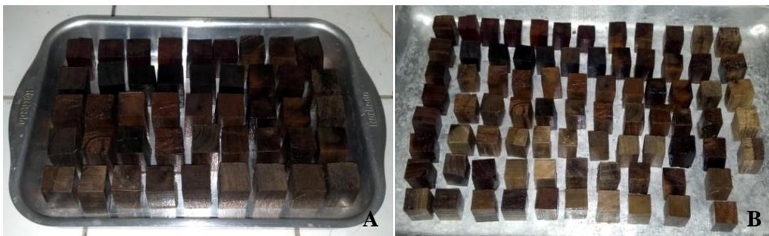
Figura 19: A e B. Preparação dos corpos de prova para estufa.
