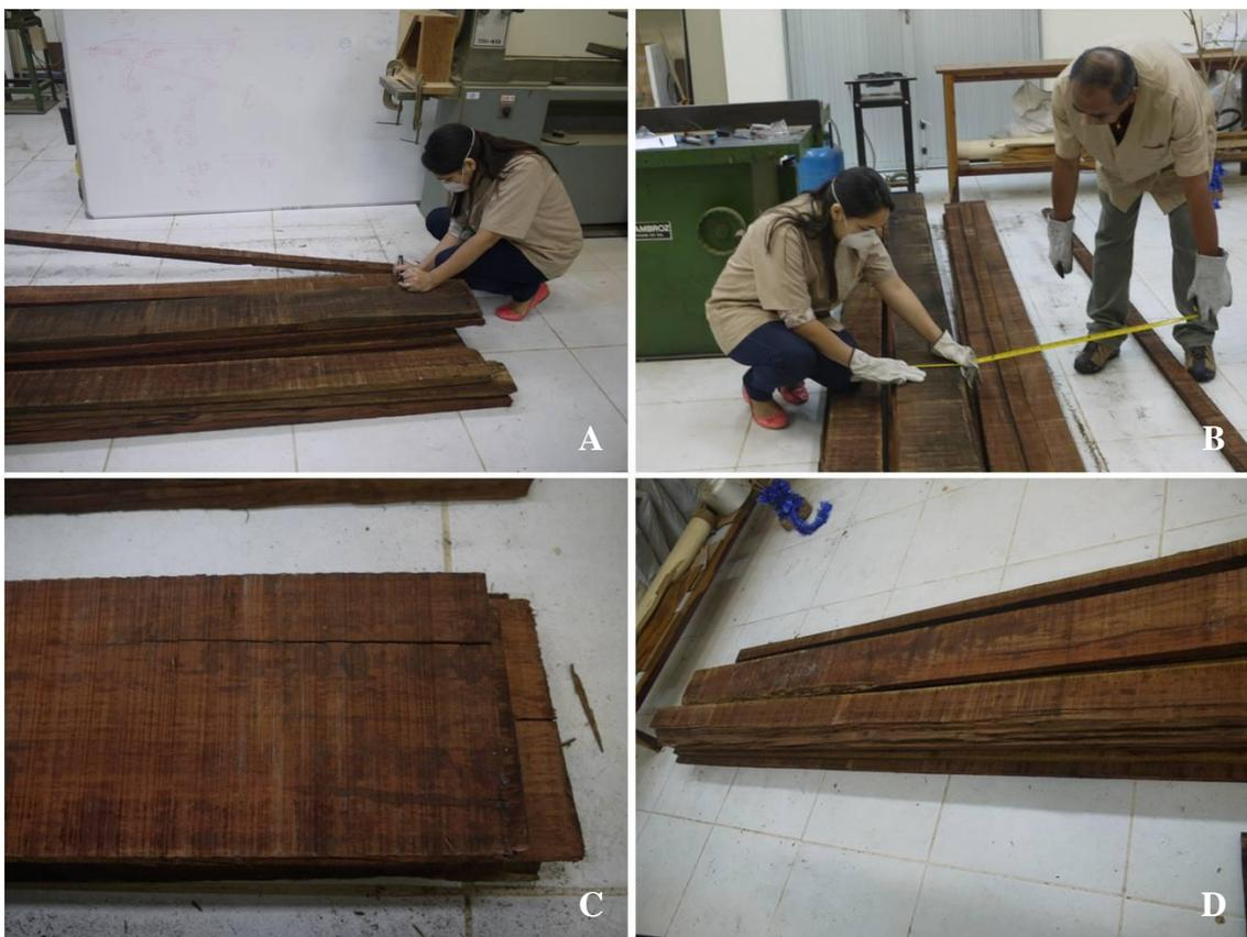
Figura 24: A. Marcação das peças; B. Medição da largura e comprimento; C. registro dos defeitos, D. Classificação por tamanho.
