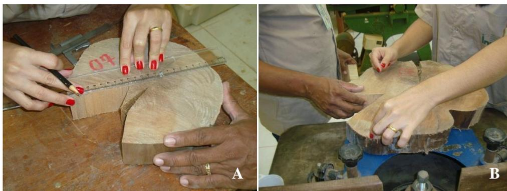
Figura 14: A. Análise do sentido dos raios; B. Retirada das amostras.
