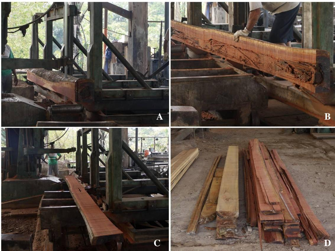
Figura 22: A. Início do desdobro; B. Retirada das peças; C. Finalização do desdobro e D. Peças resultantes à esquerda.
