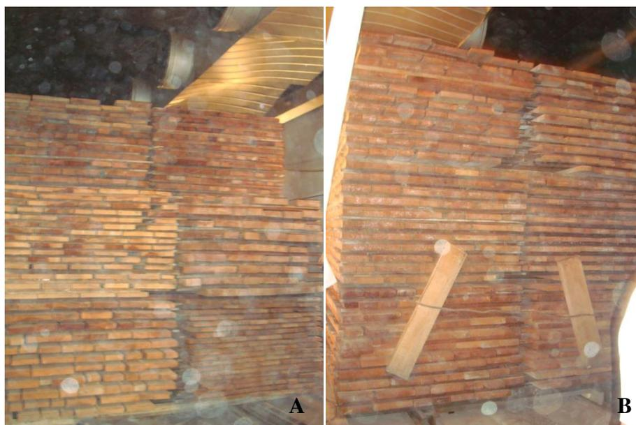
Figura 23: A. Secagem em estufa; B. Empilhamento das peças de maneira uniforme.
