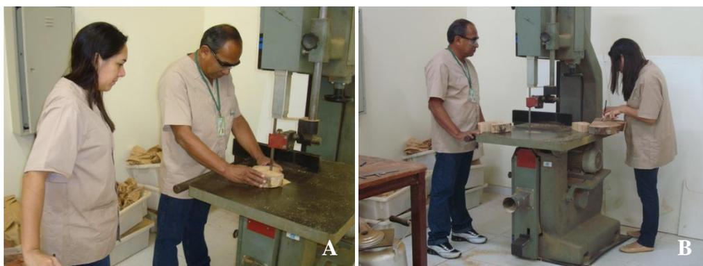
Figura 15: A. Retirada da cunha na máquina serra fita. B. Remarcação da amostra.
