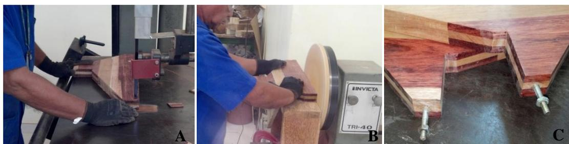
Figura 37: A. Corte de uma das pernas; B. Retirada do excesso de cola; e C. Inserção dos parafusos.
