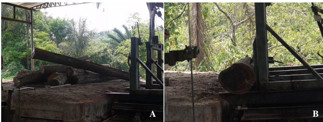
Figura 21: A. Tora aguradando o desdobro; B. Desdobro em função das características da tora.
