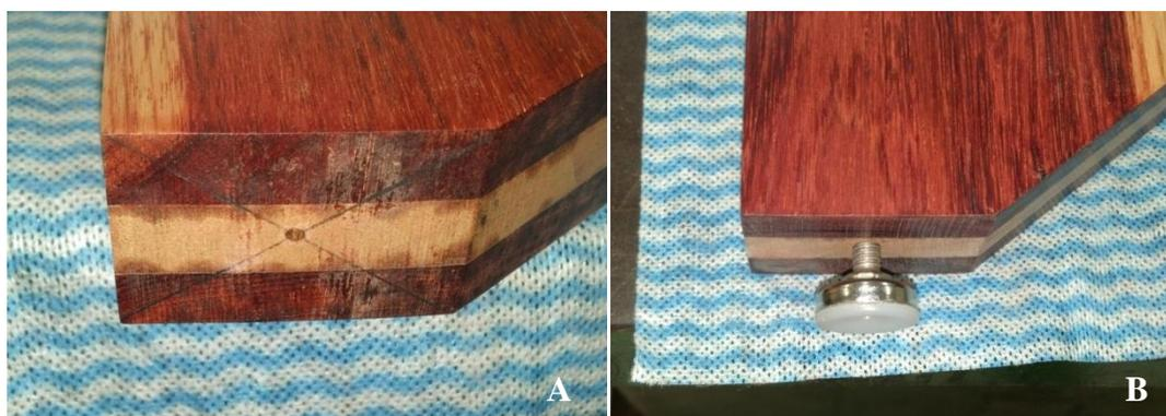
Figura 39: A. Furo realizado na parte inferior das pernas da mesa; e B. “Sapatras” rosqueadas na peça.
