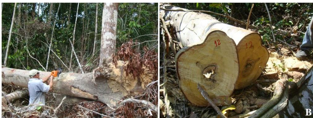
Figura 13: A. Técnico coletando os discos; B. Discos numerados no campo.
