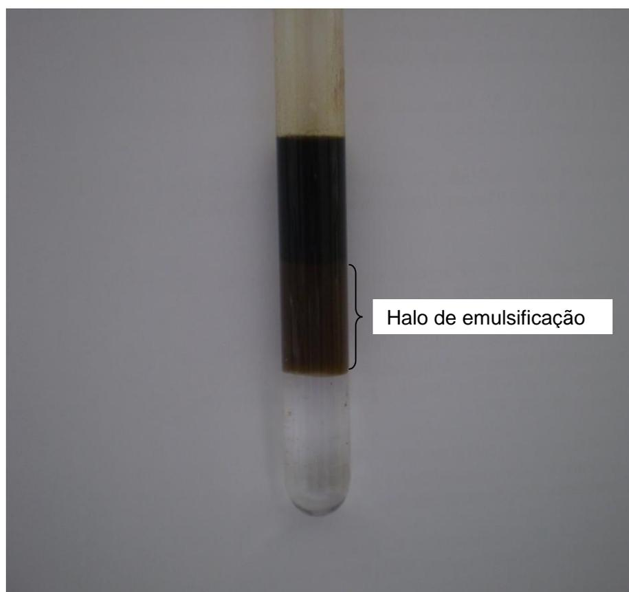
Figura 9- Halo formado no teste de emulsificação com petróleo
