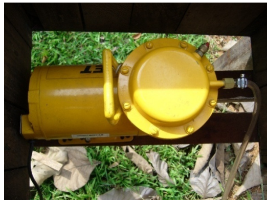
Figura13. Compressor para aeração da água.
