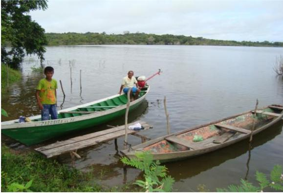
Foto 5: Rabeta – motor colocado na polpa da canoa.
