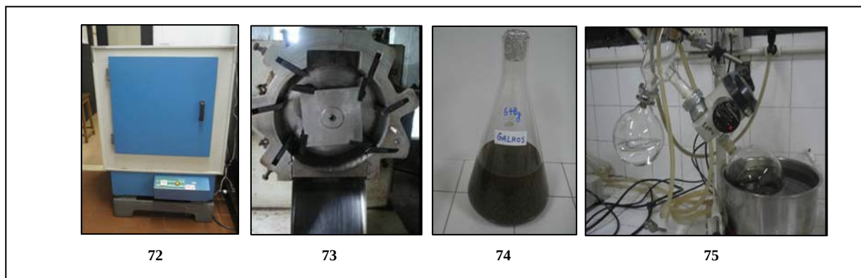
Figura 19: Preparação dos extratos: Estufa de ar circulante (72), moinho de quatro facas (73), galhos moídos em maceração (74) e evaporador rotativo sob pressão reduzida (75).
