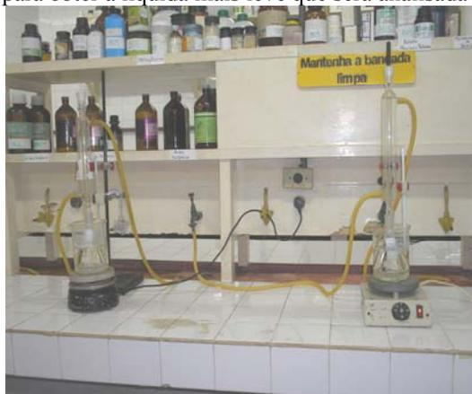
Figura 1. Sistema de refluxo usado no processo de despolimerização.
