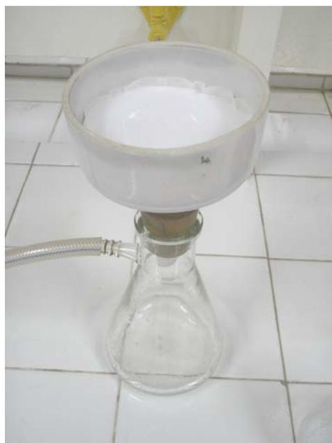
**Figura 31. Esquerda** – adição de  $\text{H}_2\text{SO}_4$  à solução pós-hidrólise do PET e **Direita** - sistema de filtração para separação do precipitado branco formado.
