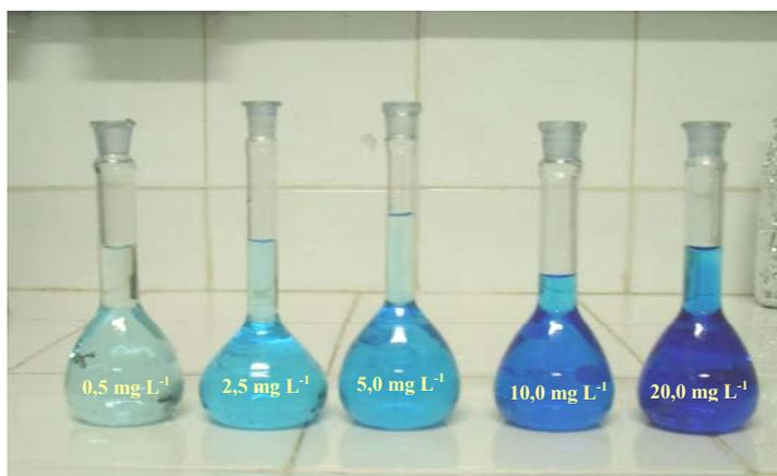
**Figura 34.** Soluções padrões de MB para construção da curva padrão, com concentração na faixa de 0,5 a 20,0  $mg L^{-1}$ .
