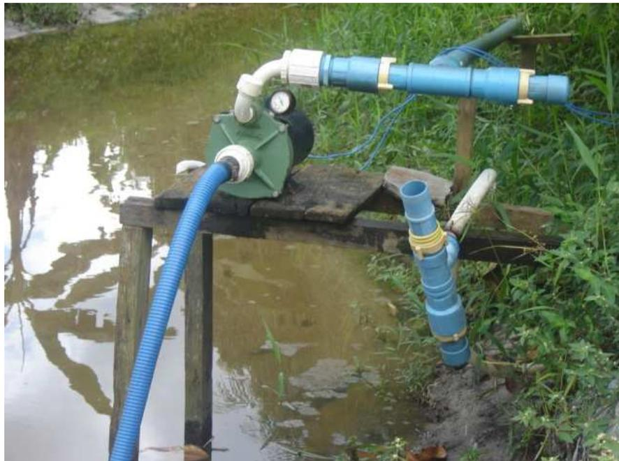
**Figura 27. Bomba hidráulica retirando água da nascente do igarapé. Fonte: AMARAL, F.L., Trabalho de Campo/2009.**
