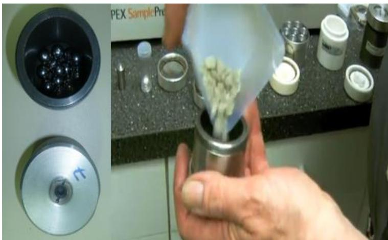
**Figura 11:** À esquerda cilindro com tampa e esferas, e à direita pó sendo adicionado ao cilindro.
