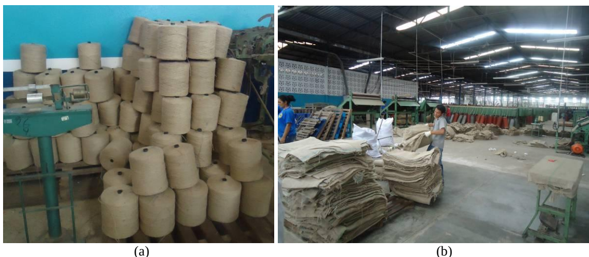
Figura 2.5 – Fibras de juta e malva beneficiadas industrialmente: (a) Cordões e (b) Sacarias.
