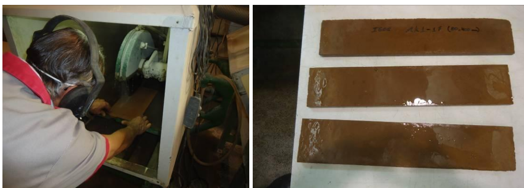
(a) (b) Figura 4.12 – Preparação das placas para ensaios mecânicos: (a) Corte das placas, (b) Amostras para o ensaio de flexão.
