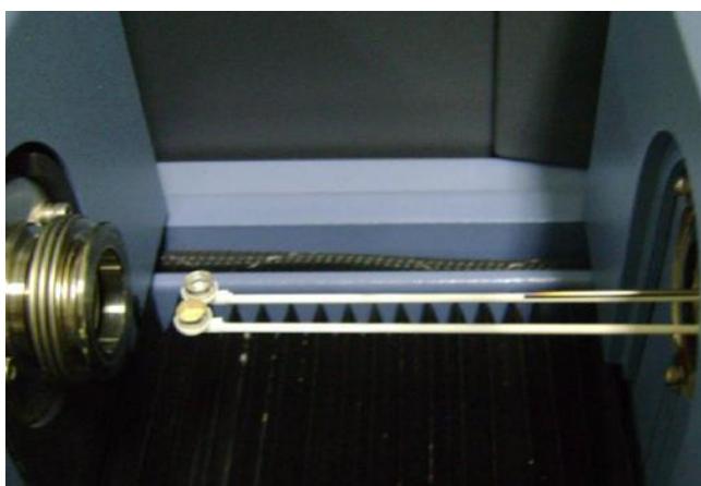
Figura 4.7 – Amostra em cadinhos de platina. Fonte: MARQUES (2009).
