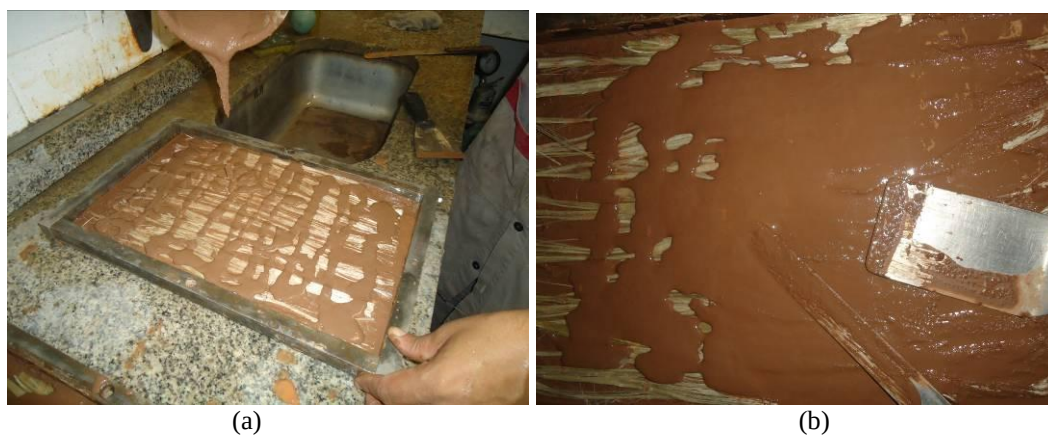
Figura 4.11 – Moldagem das placas: (a) Colocação de uma das camadas de argamassa sobre as fibras, (b) Espalhamento da argamassa na forma.
