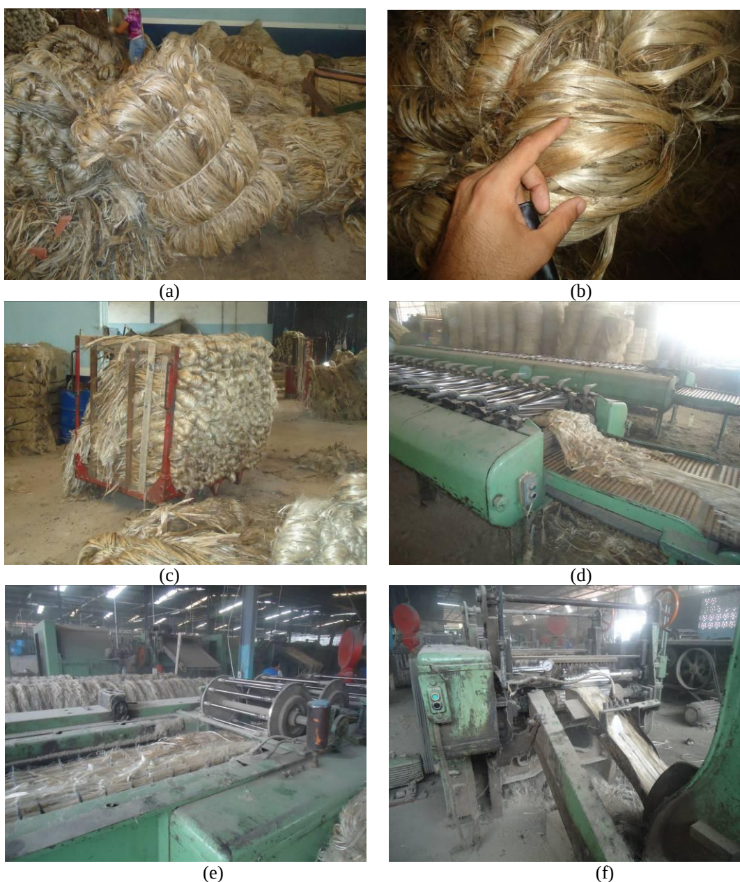
Figura A.1 – Processo industrial inicial de Beneficiamento das fibras de juta e malva: (a) Fardo, (b) Fibras de juta, (c) Codicionamento das fibras para desfiamento, (d) Limpeza das fibras através do processo de vibração, (e) Início do Processo de desfiamento, (f) Finalização do Processo de desfiamento.
